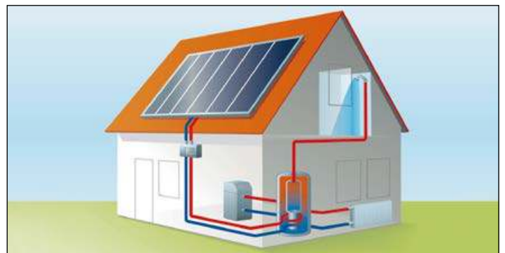
Prinzip einer Solaranlage zur Wassererwärmung und Heizungsunterstützung
