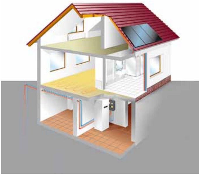
Optimierte Wärmepumpennutzung: Tiefenbohrung - Fußbodenheizung und Solarenergienutzung. Abbildung: Viessmann Werke.
